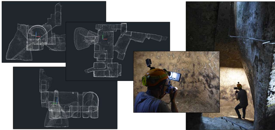
Figura 1. Risultati e fasi della campagna di rilievo con fotogrammetria digitale tradizionale.
