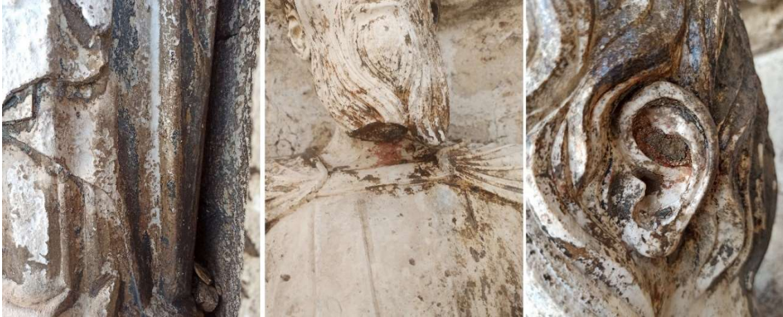
Figura 3. Monopoli, Muraglione. Particolari delle tracce di verde bruno, dei frammenti di incarnato e degli strati disomogenei di colore bruno traslucido. Nel primo caso la pigmentazione scura è resa dalla presenza di nero carbonioso, di piccole quantità di ocre gialla e terra verde. Al di sotto, si osserva una patina di tonalità gialla a base di carbonato di calcio, miscelato a minore biacca dalla macinazione fine: la colorazione è data dalla presenza di pigmenti di tipo tradizionale quali l'ocra gialla. Dalle analisi delle matrici organiche risulta la presenza di ossalati di calcio, derivanti dalla trasformazione e dall'invecchiamento di sostanze di origine organica, verosimilmente colla animale.
