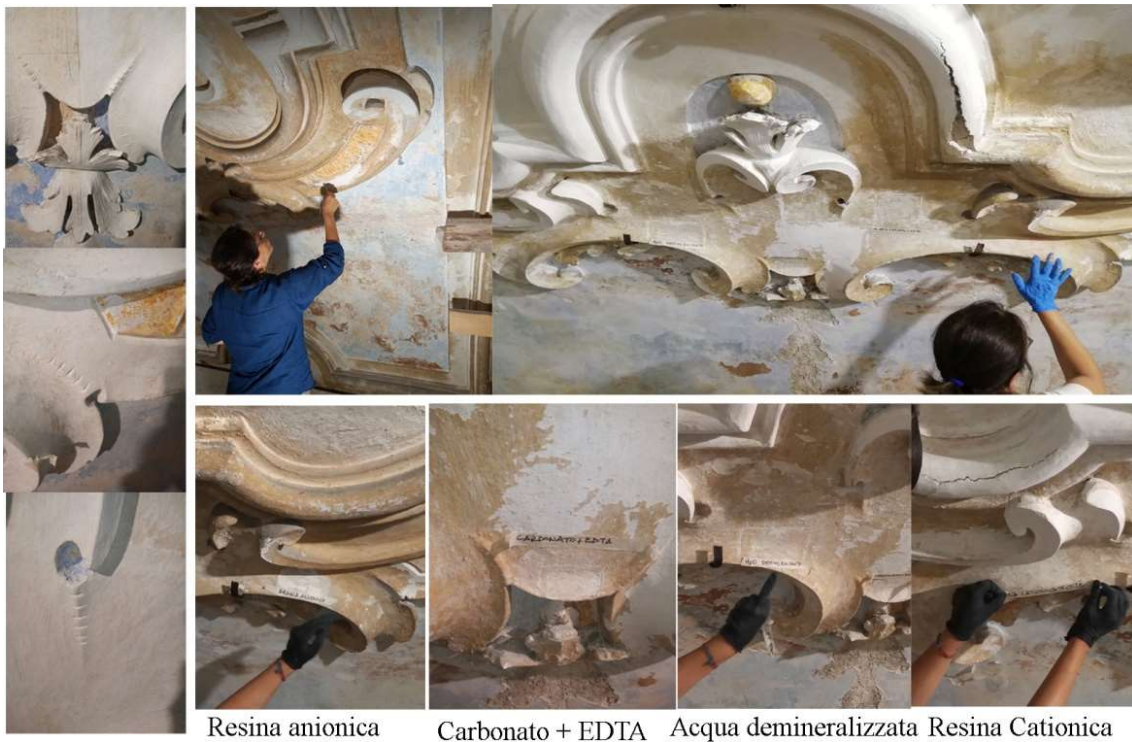
Figura 2. Saggi di pulitura chimica degli strati di alterazione carbonatati.
