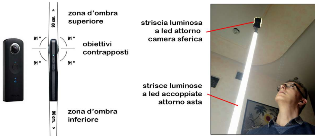
Figura 2. Sistema di autoilluminazione per fotocamera sferica Ricoh Theta S.
