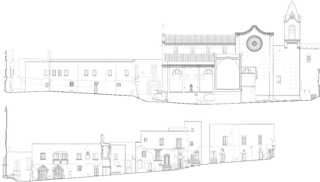
Figura 4. Rilievo dei fronti urbani di via Giacomo Arpone – Largo Giuseppe Spennati e Largo Arcid. Teodoro Trincherà e del fronte orientale dell'Arco Scoppa a Ostuni.
