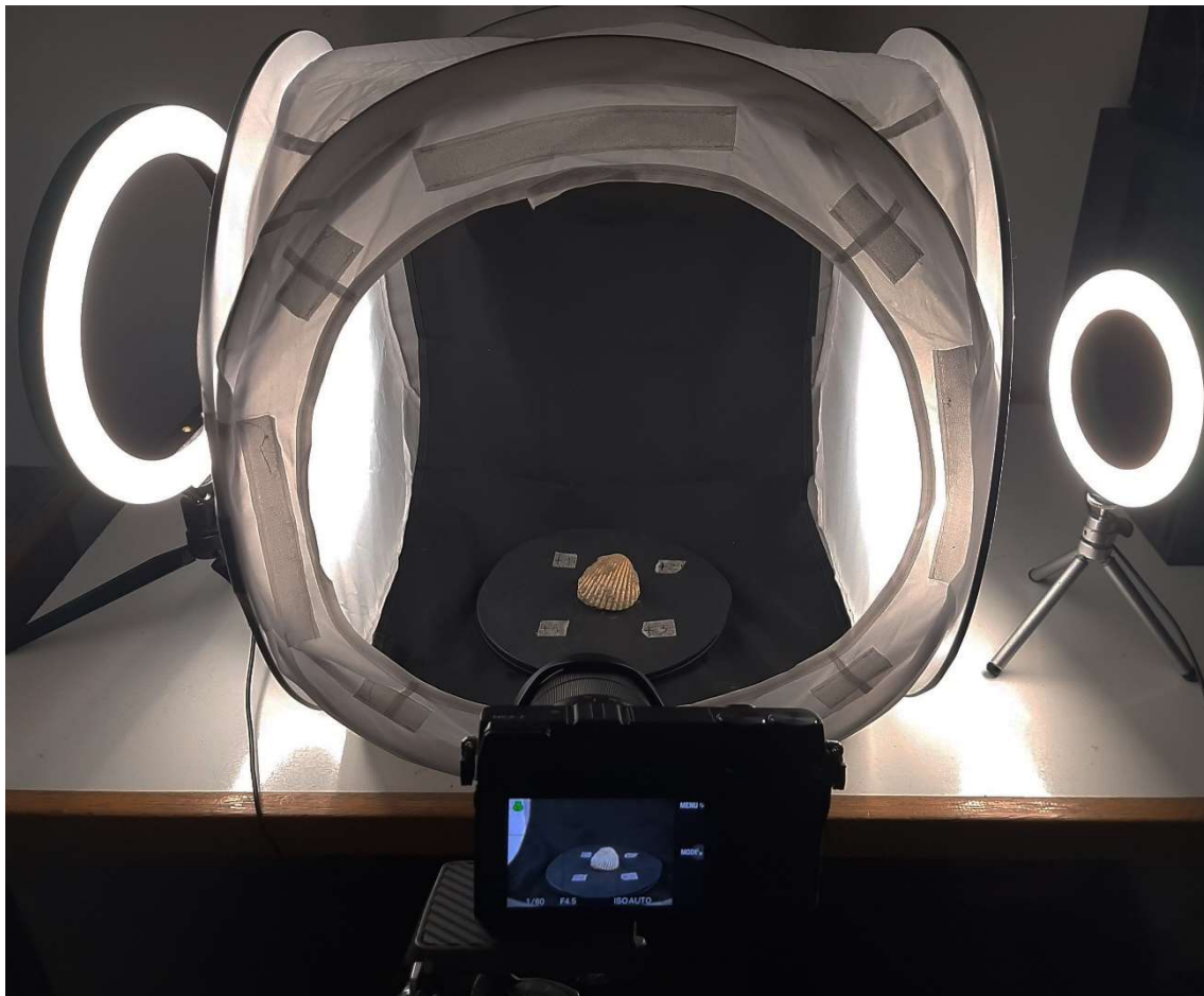
Figura 1. Attrezzatura base per realizzare un rilievo fotogrammetrico di un oggetto di piccole dimensioni.
