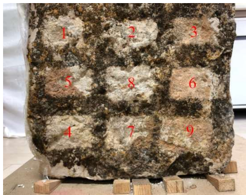
Figura 3. Risultato dei saggi: tasselli 1-2-3-prove Nasier Lapideo L01; tasselli 4-5-6-prove BioTersus; tasselli 7-8-9-prove Biotin T
